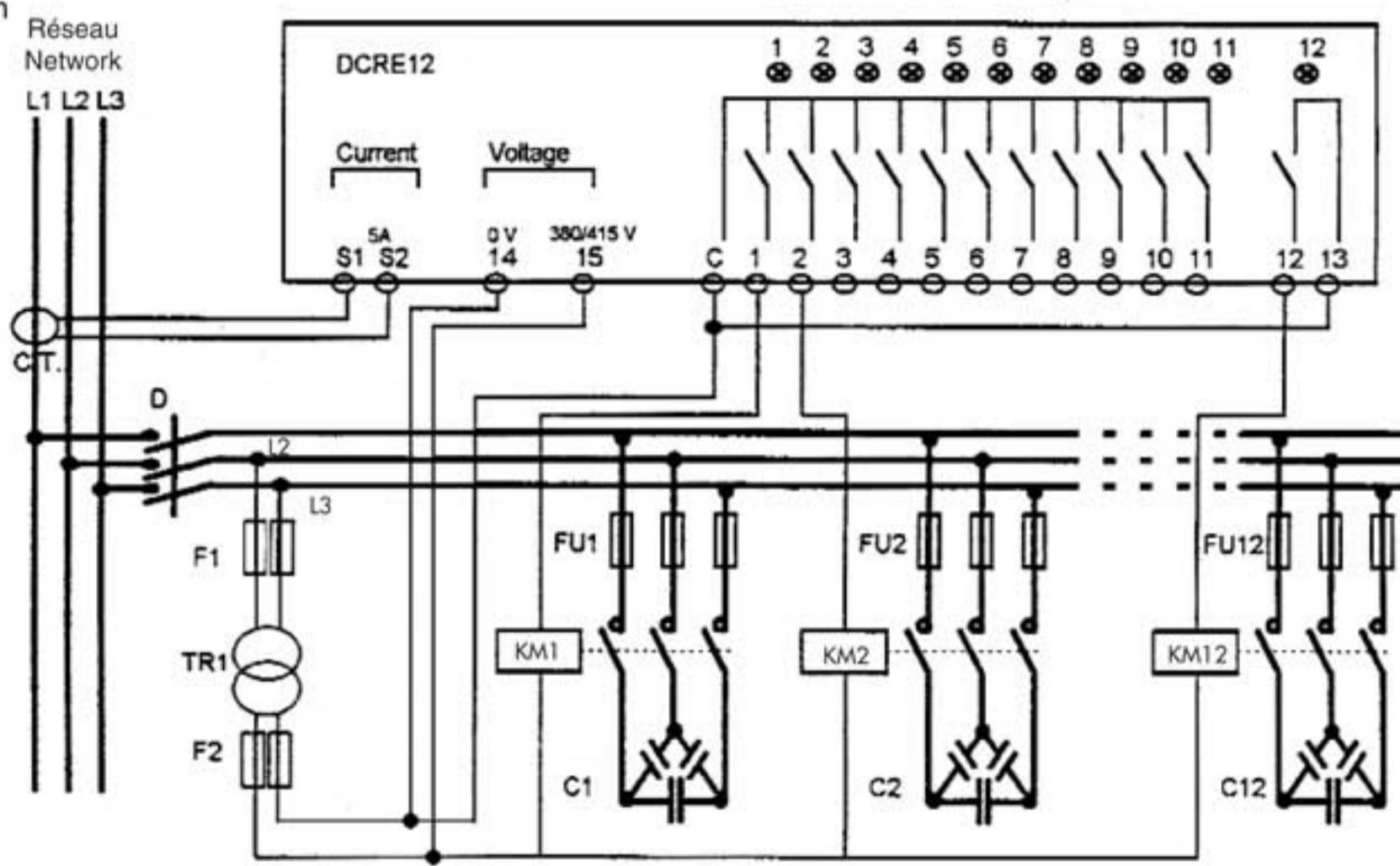
TR1 : transformateur circuits auxiliaires si U réseau > 415Vac
